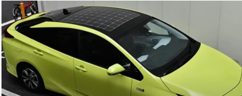
第4世代プリウスのオプションで太陽光発電を搭載した場合の外観
