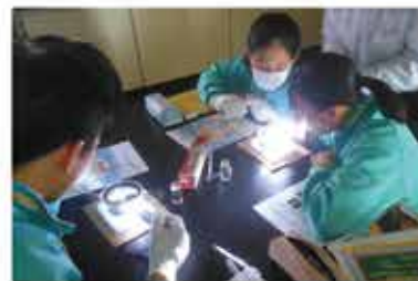
懐中電灯で照らしながら、放射線の飛跡を観察します。アルファ線、ベータ線の飛跡をきれいに見ることができます
