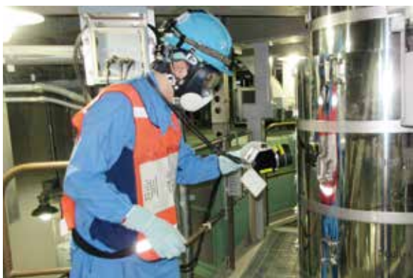
D/Wにおける線量測定訓練 [写真：東北電力提供]
