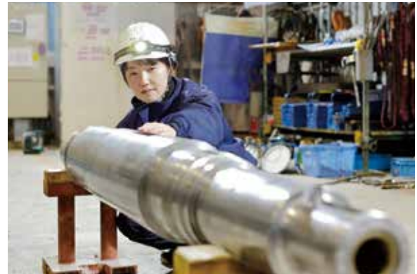
協力会社がメンテナンスを行った排煙脱硫装置の部品を前に、目視での傷の有無確認や図面との照合を行います。「いろいろな人と交流し、話しやすい雰囲気をつくるために普段から雑談をするようにしています」と阿部さん
