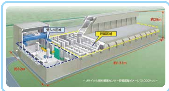
搬入されたキャスクは、備蓄センター建屋内で、輸送(電力会社)-貯蔵(RFS)間の受け渡しが行われます[イメージ図RFS提供]
