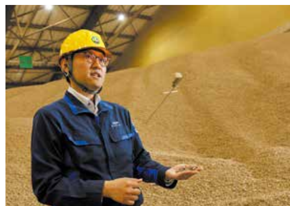
貯蔵庫では発酵による発熱で発火するのを防ぐため随所に温度計を設置してモニタリングし、また目視確認も行います。
