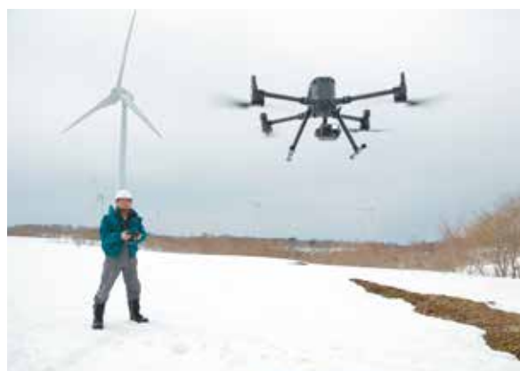
ドローンに搭載されたカメラ映像による風車ブレードや送電線の点検。現在は、ドローンにオートフライト（自律飛行）機能が搭載されています。
