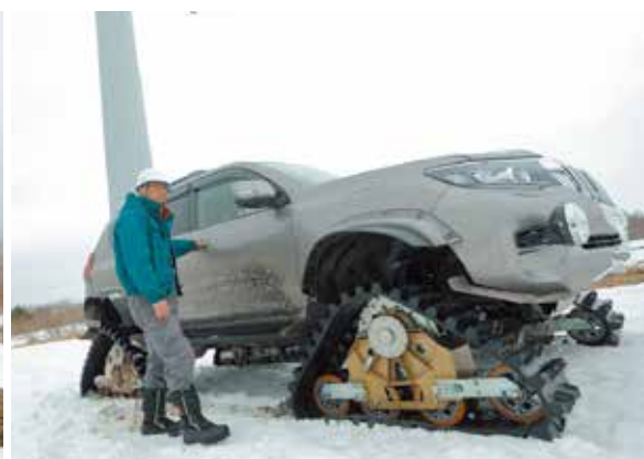
タイヤの代わりにゴムクローラーを装備した雪上車。クローラーには上下に動く4つの車輪を備え、雪面を確実に捉えて走行できます。
