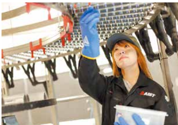
装置上部にはたくさんのノズルが取り付けられており、そこから水滴を落とすレインエロージョン試験装置。
