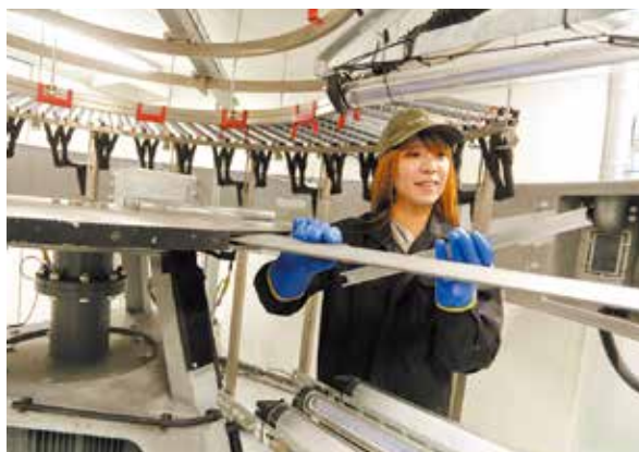
風車ブレードの前縁部分を模擬した試験片を取り付ける栗飯原さん。室外に出た後にこのブレードを回転させ、実験を行います。
