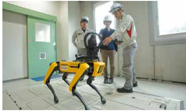
屋外の点検用に導入が検討されている4足歩行ロボット。360度を見渡せるカメラと周囲の音を拾うマイクが搭載されていて、遠隔で周囲の状況を確認することができます。
