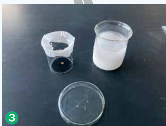
③黒い紙の上にモナズ石をのせてペトリ皿で蓋をします。
