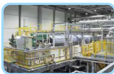
内部にある 10MW 級の大型アルカリ水電解装置。水はそのままでは電気を通しにくいので、アルカリ性にしてから電気分解を行います。
