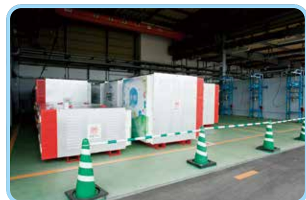
水素を運搬するためのカードル（集合容器）。内部はガスボンベがいくつも束になって入っている構造になっています。小さい方は道の駅で、大きい方はJビレッジでの発電に使われています。
