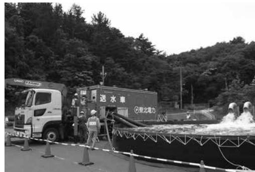
▶代替注水車(可搬式ポンプ)での水源確保訓練。貯水タンクなどから原子炉や使用済燃料プールに注水するための水源(復水貯蔵槽)へ冷却水を補給する
