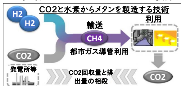
参考図25 CO 2 の原燃料化（低コストメタネーション）
