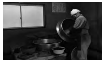
▲星(火薬の粒)を丸く大きくする星掛作業
